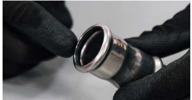
30. attēls — blīvgredzenu pārbaude
